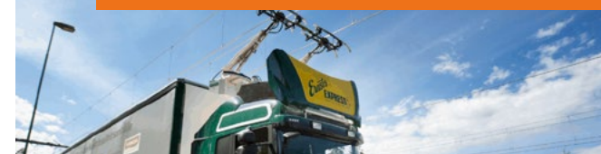
Siemens och Region Gävleborg. Konduktiv överföring via luftledning. Har demonstrerats sedan 2016 och pågick till våren 2020.
