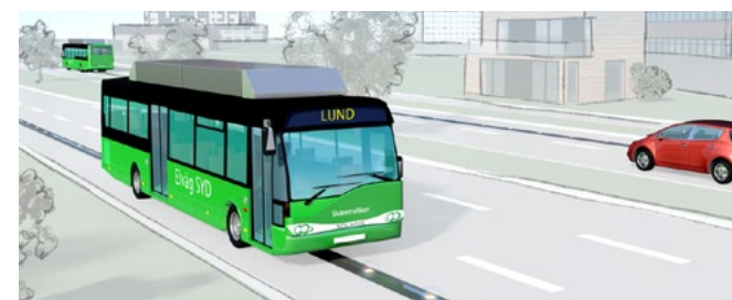
Evolution road som byggs av Elonroad i Lund under 2020. Konduktiv överföring med ledningar i vägen. Fordon kan laddas när de kör och står stilla. En buss kommer att trafikerar sträckan i en separat fil. Pågår till 2022.
