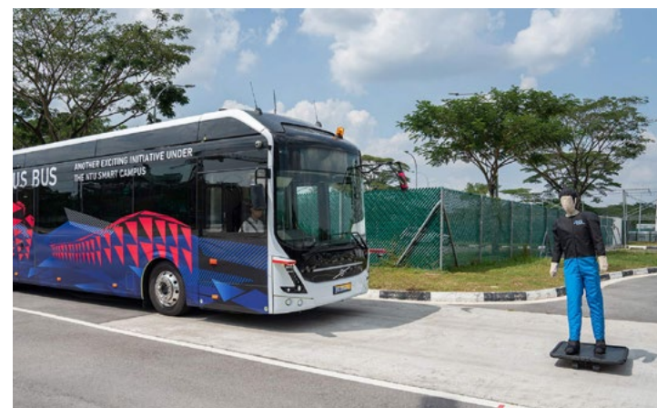
Volvo och Nanyang Technological University. Världens första autonoma 12-metersbuss körs idag i Singapore och är utrustad med sensorer och navigeringskontroll där styrningen sker via ett AI-system.
