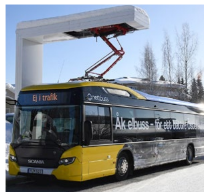
En eldriven buss utvecklad av Scania laddas i Östersund via en pantograf-lösning. Processen tar 6-7 minuter.
